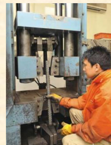
碳钢钢筋的拉伸强度测试
